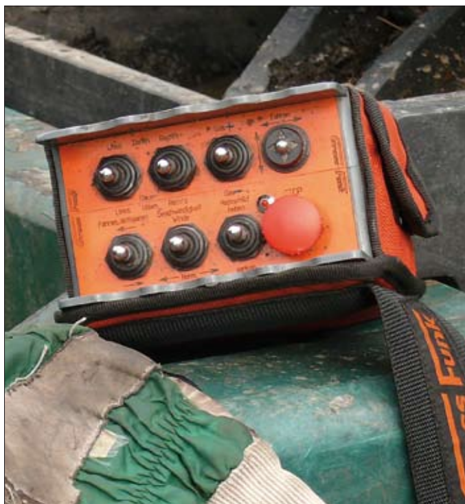
Abb. 1: Leicht und kompakt gebaute Funkfernsteuerung
