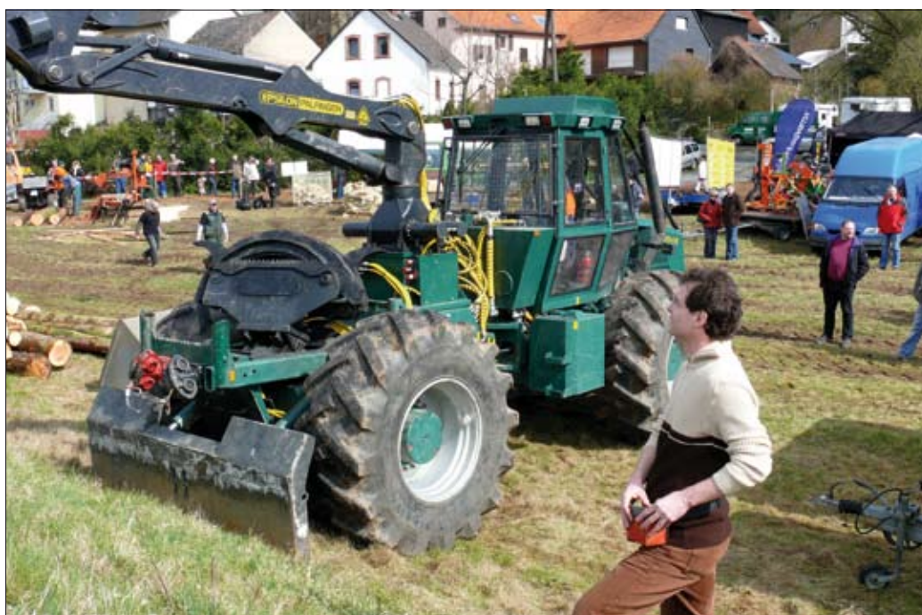
Abb. 2: Bernd Konrad hat per Funk alle Funktionen der Rückemaschine im Griff.
